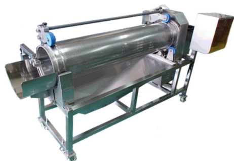
飛散防止カバー 取り外し時
